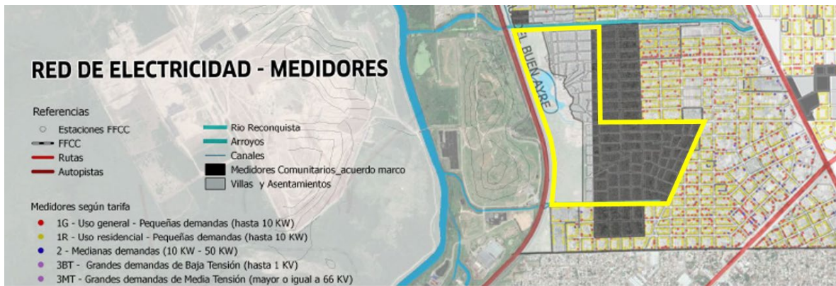
Figura 54 Detalle de cobertura red eléctrica con medidores comunitarios AID
